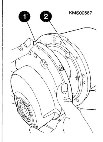
ASSEMBLING REDUCTION GEAR (TYPE TF 0 001 613 ...)
